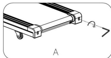
2. Ako se **traka za trčanje** pomera **ulevo**, vijak za podešavanje na levoj strani okrenite  $\frac{1}{4}$  u smeru kazaljke na satu, a zatim desni vijak za podešavanje okrenite  $\frac{1}{4}$  u smeru suprotnom od kazaljke na satu. Ako se traka ne pomera, ponovite ovaj korak sve dok se ne centriira. Pogledajte sliku B.
