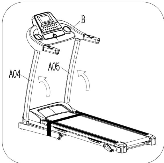
Podignite konzolu (B) i lijevu i desnu uspravnu cijev (A04, A05) prema smjeru strelice.
