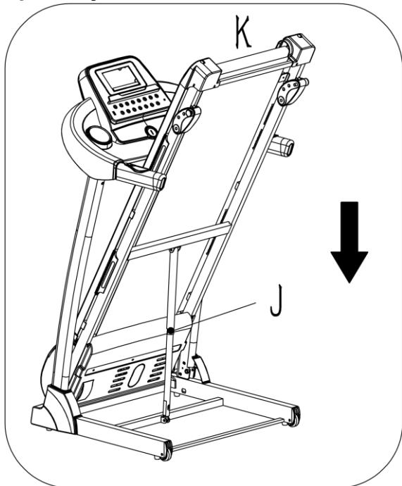
Držite mjesto K rukom, lagano pritisnite okvir, zatim gurnite mjesto J, i osnovni ram će se automatski spustiti.
