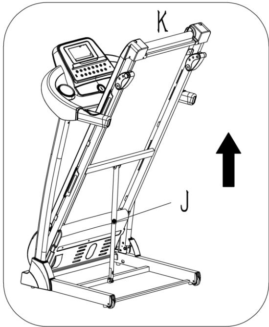
Rukom poduprite mesto K, a zatim povucite prema gore u smeru strelice, dok ne čujete zvuk da je CILINDAR (J) zaključan u okrugloj cevi.
