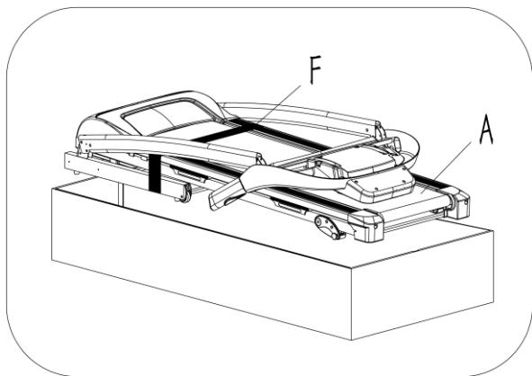
Otvorite kutiju i uklonite sadržaj. Postavite **glavni ram** (A) na ravan teren, osigurajte da imate radnu površinu koja je čista i ima dovoljno prostora. **Nemojte seći ambalažnu traku (F) pre nego što završite montažu.**
