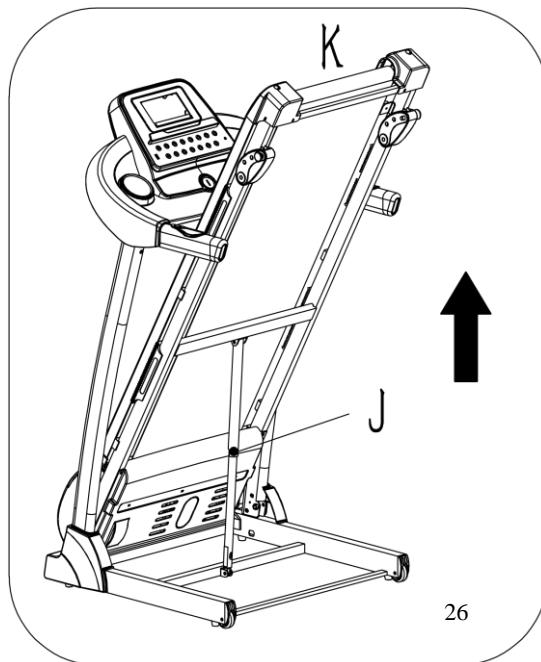
Rukom poduprite mjesto K, a zatim povucite prema gore u smjeru strelice, dok ne čujete zvuk da je CILINDAR (J) zaključan u okrugloj cijevi.
