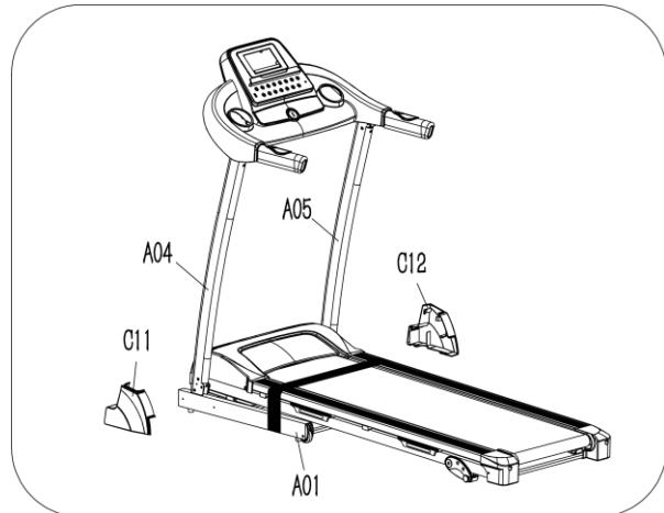
Gurnite **poklopac lijeve i desne cijevi** (C11, C12) na **osnovni ram** (A01), i **lijevu i desnu uspravnu cijev** (A04, A05).
