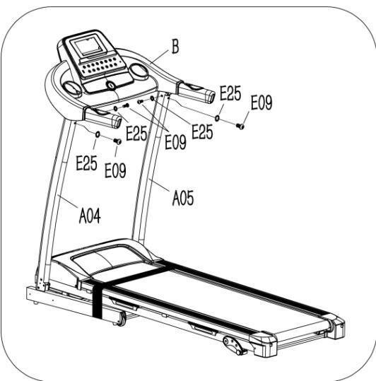
Upotrijebite 5 # inbus ključ (B08) i M8\*15 vijak (E09) i **sigurnosnu podlošku** (E25), **konzolu** (**B**) zaključajte na **lijevu i desnu uspravnu cijev** (A04, A05).
