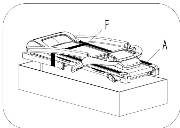
Otvorite kutiju i uklonite sadržaj. Postavite **glavni ram** (A) na ravan teren, osigurajte da imate radnu površinu koja je čista i ima dovoljno prostora. **Nemojte rezati ambalažnu traku (F) prije nego što završite montažu.**
