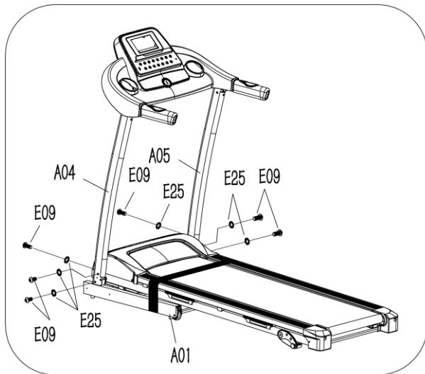
Upotrebite 5 # inbus ključ (B08) i M8\*15 vijak (E09) i sigurnosnu podlošku (E25), zaključajte levu i desnu uspravnu cev (A04, A05) na **glavni ram** (A01).
