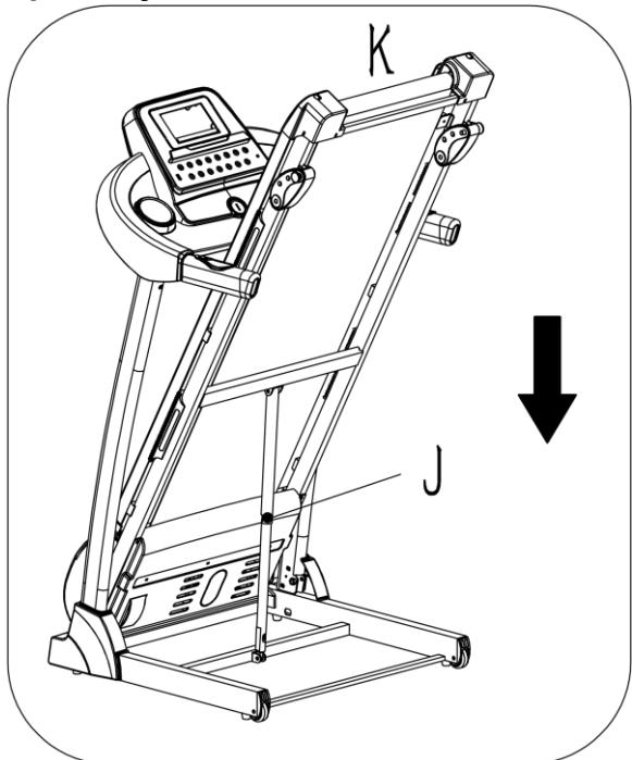
Držite mesto K rukom, lagano pritisnite okvir, zatim gurnite mesto J, i osnovni ram će se automatski spustiti.
