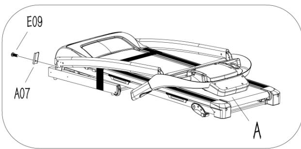
Otpustite vijak (E09) na glavnom ramu (A) pomoću # 5 inbus ključa (B08) i uklonite sigurnosni blok (A07).
