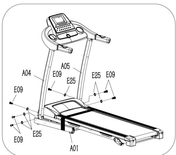
Upotrijebite 5 # inbus ključ (B08) i M8\*15 vijak (E09) i sigurnosnu podlošku (E25), zaključajte lijevu i desnu uspravnu cijev (A04, A05) na glavni ram (A01).
