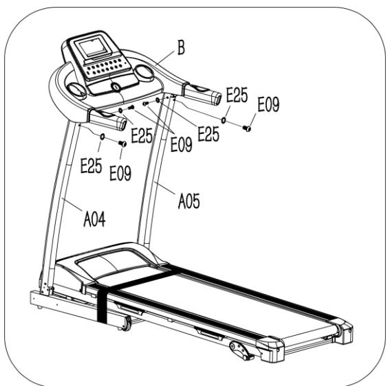
Upotrebite 5 # inbus ključ (B08) i M8\*15 vijak (E09) i **sigurnosnu podlošku** (E25), **konzolu** (B) zaključajte na **levu i desnu uspravnu cev** (A04, A05).
